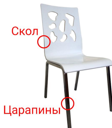
Рисунок 1 – Дефекты пластмассового стула
